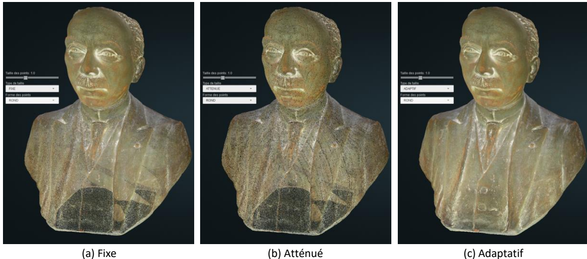
Fig. 17. Rendus obtenus en fonction du paramètre "Point sizing": fixe, atténué et adaptatif.
