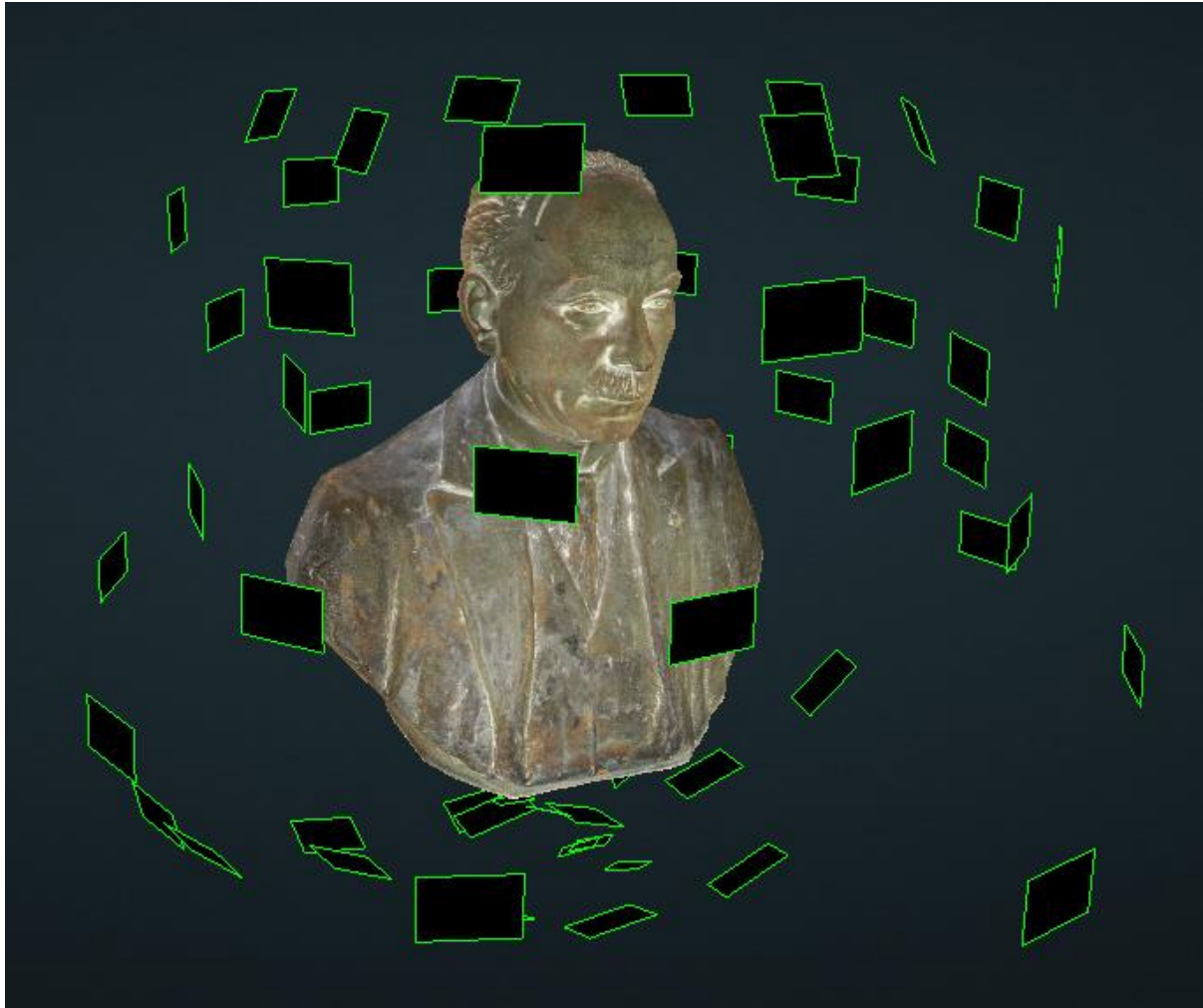
Fig. 2. Modèle 3D avec l'ensemble des photographies disponibles positionné dans l'espace sous forme de vignette.
